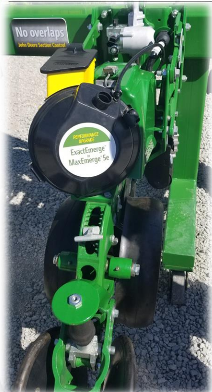
Dosificador neumático para alta velocidad de siembra MaxEmerge 5e
