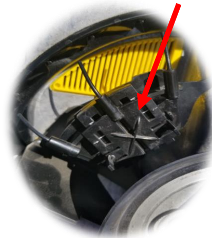
Rasador regulable según tamaño de semilla
